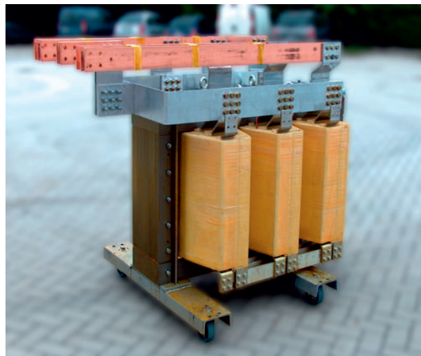
5-ти ступенчатый 800 кВА – трансформатор для применения в гальванотехнике
